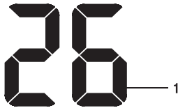
1 – Индикатор текущей температуры
