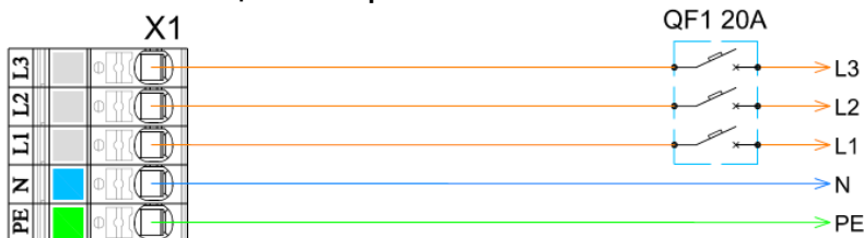
Рис. 5 Схема подключения электропитания 3 фазы 380-400 В / 50-60 Гц. Мощность нагревателя 12 кВт
