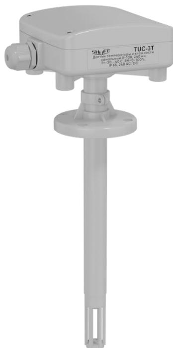
Канальный датчик температуры и влажности TUC-3T это измеритель температуры и уровня относительной влажности в каналах систем вентиляции. Измеренные датчиком параметры влажности преобразуются в нормированный выходной сигнал 0-10 В. Преобразователь предназначен для использования в неагрессивной среде и измерения параметров воздуха в каналах систем вентиляции и кондиционирования.
