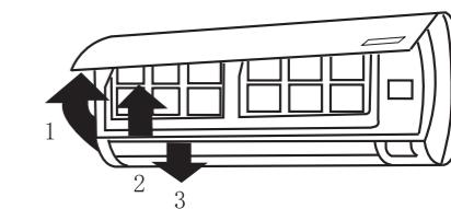
1. Отключите прибор и снимите фильтр
