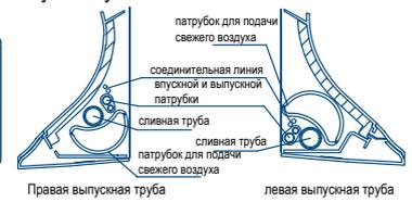
Примечание: расположении трубопровода налево или направо располагайте его так, как показано на рисунке, в противном случае это повлияет на монтаж!
