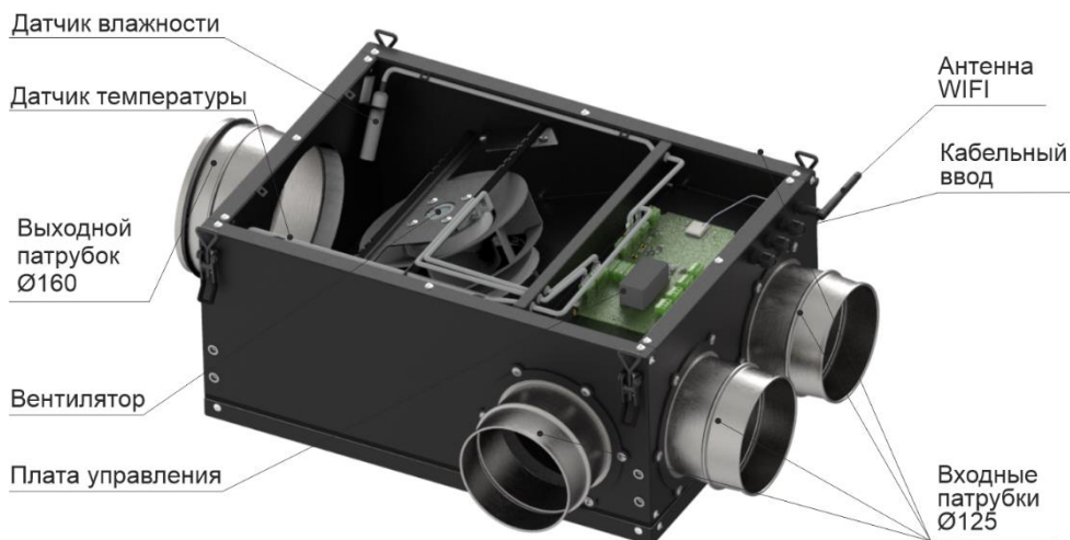
Рис. 1. Устройство вытяжной установки
