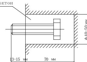
**4.1.3** Как только цементный раствор затвердеет, закрепите монтажную пластину (используйте прокладку и гайку согласно схеме).
