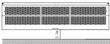
3.4 Если ширина входа в помещение превышает размер агрегата, рекомендуется установить несколько воздушных завес над выходом с расстоянием 20-40 мм между ними.
