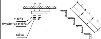
4.3.3 Установите монтажную пластину на потолочное крепление и убедитесь в надежности крепления (используйте болты, ввинченные в потолочное крепление, как показано на Рис.) Для подпотолочного монтажа используйте потолочное крепление, центровка монтажной пластины может осуществляться в диапазоне 100 мм.
