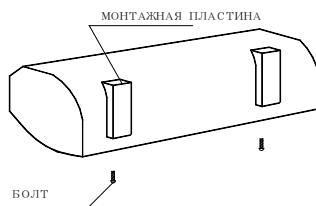
**4.3.2** Зафиксируйте потолочное крепление, см. рисунок ниже:
