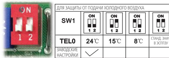
А. Микропереключатель SW1 предназначен для выбора температуры остановки вентилятора внутреннего блока (TELO), когда он находится в режиме предотвращения подачи холодного воздуха в режиме нагрева. Диапазон значений: 24 °C, 15 °C, 8 °C, в соответствии с настройками ЭСППЗУ (зарезервировано для специальных настроек).
