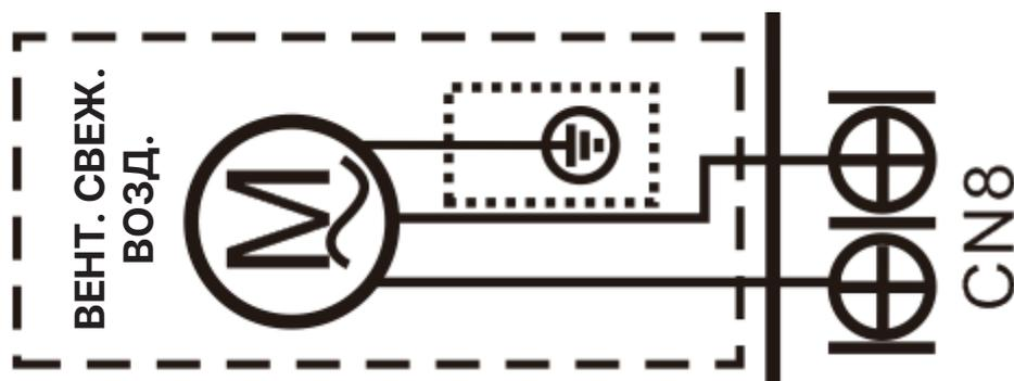
С. Для двигателя свежего воздуха используется разъем CN8
