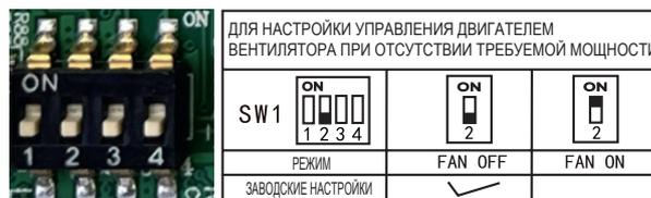
Микропереключатель SW1-2 предназначен для выбора ДЕЙСТВИЯ ВЕНТИЛЯТОРА внутреннего блока, когда температура в помещении достигает заданного значения и компрессор выключается.
