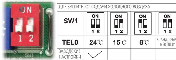
А. Микропереключатель SW1 предназначен для выбора температуры остановки вентилятора внутреннего блока (TELO), когда он находится в режиме предотвращения подачи холодного воздуха в режиме нагрева. Диапазон значений: 24 °C, 15 °C, 8 °C, в соответствии с настройками ЭСПЗУ (зарезервировано для специальных настроек).
