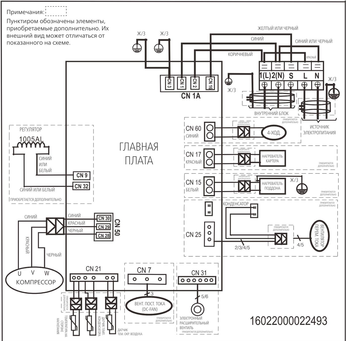
Электрическая схема наружного блока KSUNB105HZRN1
