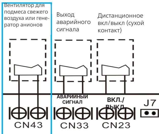
А. Разъем для дополнительного двигателя вентилятора подачи свежего воздуха (также для генератора анионов) CN43.
