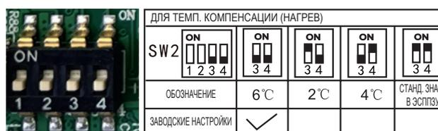
Д. Микропереключатель SW2-3 и SW2-4 предназначены для выбора температурной компенсации в режиме нагрева. Это помогает уменьшить реальную разницу температур у потолка и около пола, чтобы кондиционер мог работать нормально. Чем ниже высота установки, тем меньшее значение можно выбрать.
