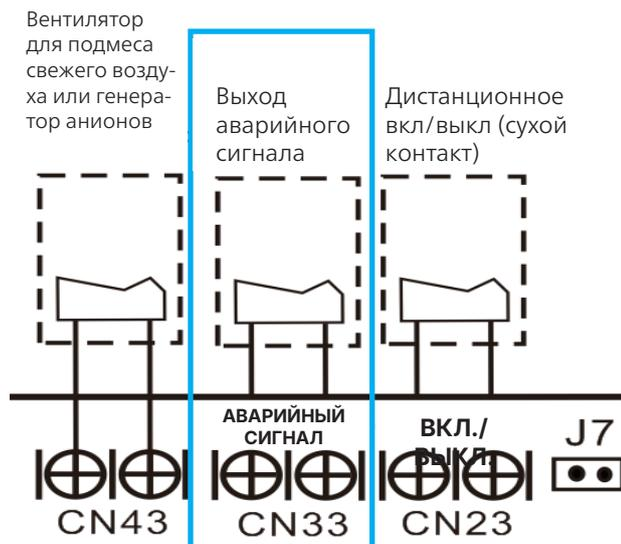
В. Для АВАРИЙНОГО СИГНАЛА служит разъем CN33
