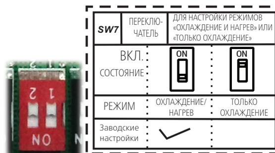
F. Микропереключатель SW7 предназначен для выбора режима охлаждения и нагрева или режима только охлаждения. Состояние: охлаждение и нагрев, охлаждение.
