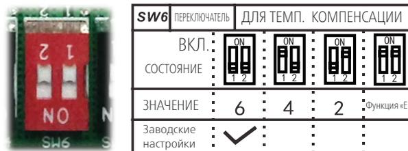
E. Микропереключатель SW6 предназначен для выбора температурной компенсации в режиме нагрева. Это помогает уменьшить реальную разницу температур у потолка и около пола, чтобы кондиционер мог работать нормально. Чем ниже высота установки, тем меньшее значение можно выбрать. Диапазон значений: 6 °C, 4 °C, 2 °C, функция E (зарезервирована для специальных настроек).
