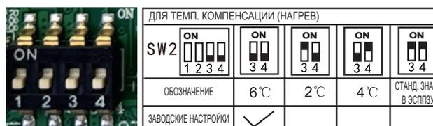
Микропереключатель SW2-1 и SW2-2 предназначены для выбора температуры остановки вентилятора внутреннего блока (TEL0), когда он находится в режиме предотвращения подачи холодного воздуха в режиме нагрева.
