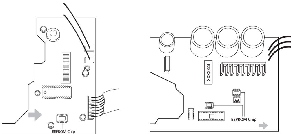
**Примечание:** У некоторых моделей печатную плату наружного блока нельзя снять отдельно. В этом случае необходимо заменить блок электрического управления наружного блока в сборе. Данные иллюстрации приведены только в качестве справочных, фактический внешний вид устройства может отличаться.
