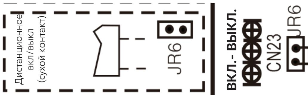
А. Для дистанционного управления (ВКЛ. и ВЫКЛ.) служат разъем CN23 и короткозамкнутая перемычка JR6.
