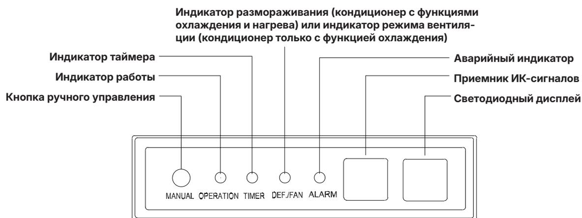
Компактный кассетный блок
