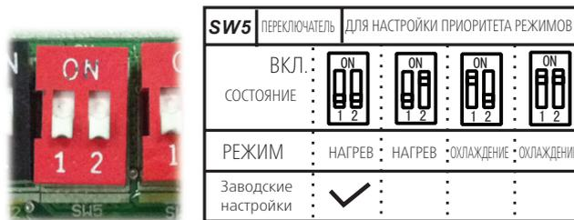
D. Микропереключатель SW5 предназначен для настройки ПРИОРИТЕТА РЕЖИМА работы при использовании блока в составе мультисистемы. Состояние: нагрев, охлаждение.
