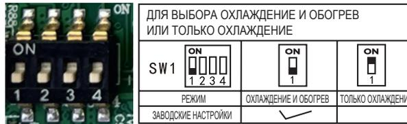
А. Микропереключатель SW1-1 предназначен для выбора режима охлаждения и нагрева или только охлаждения.
