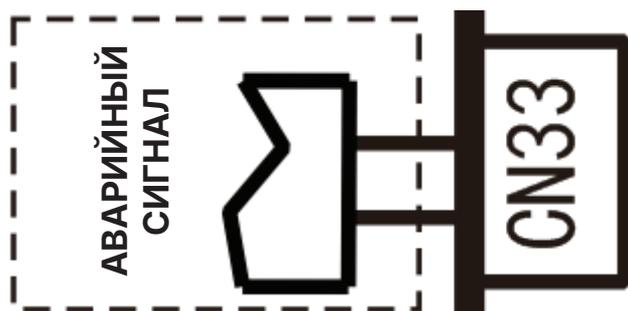
В. Для АВАРИЙНОГО СИГНАЛА служит разъем CN33
