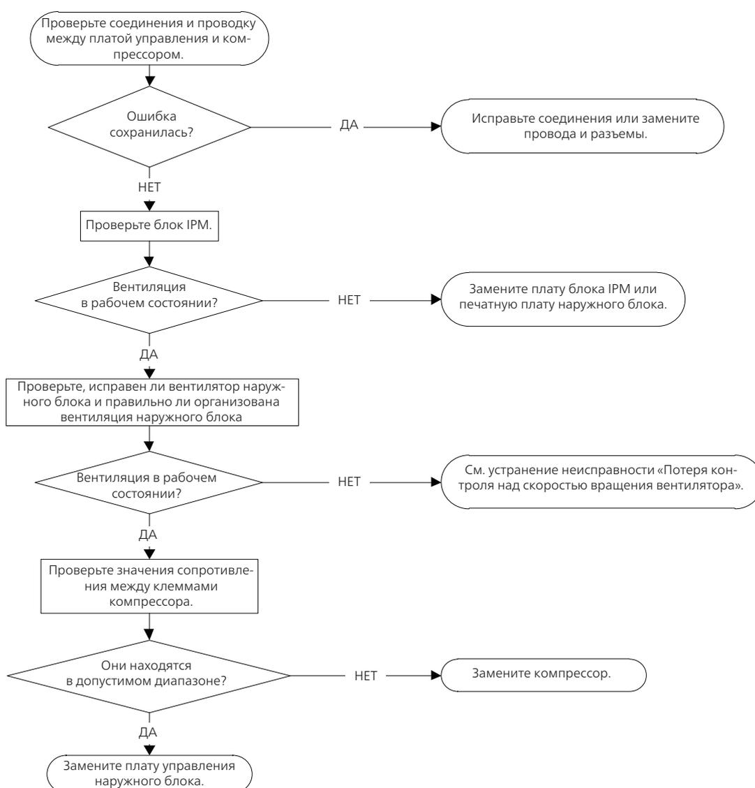
**Примечание:** У некоторых моделей печатную плату наружного блока нельзя снять отдельно. В этом случае необходимо заменить блок электрического управления наружного блока в сборе.
