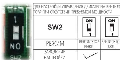
Микропереключатель SW2 предназначен для выбора ДЕЙСТВИЯ ВЕНТИЛЯТОРА внутреннего блока, когда температура в помещении достигает заданного значения и компрессор выключается.
