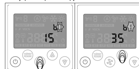
Кнопка «вентилятор» переключит режим смены группы на режим выбора параметра. Режим выбора номера параметра Режим выбора номера параметра
