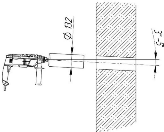
Рис. 3. Бурение отверстия.
