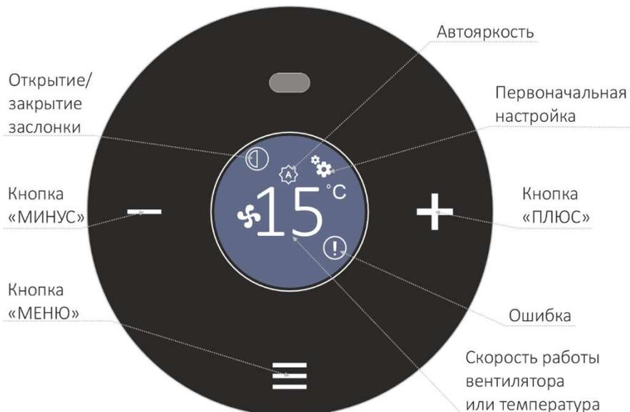
Рис. 8. Обозначение иконок экрана и кнопок управления прибора
