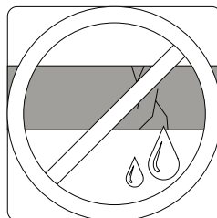
Проверьте отсутствие течей
