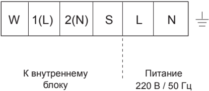
Клеммы для подключения проводов на наружном блоке
