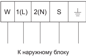
Клеммы для подключения проводов на внутреннем блоке
