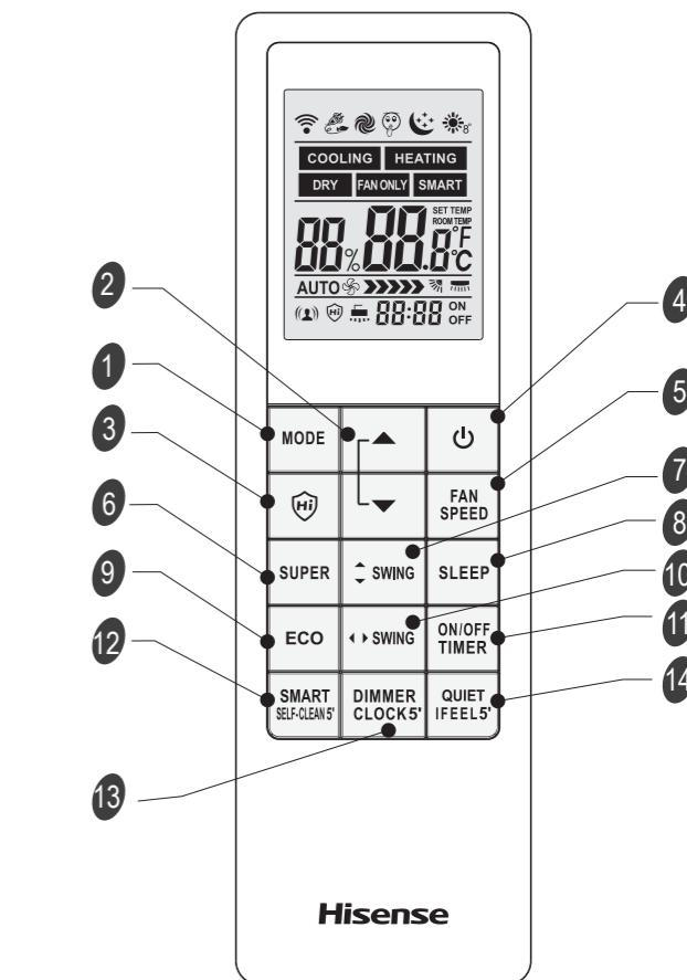
Когда кондиционер выключен, а на пульте ДУ выбран режим охлаждения или осушения, нажмите и удерживайте кнопку SMART в течение 5 сек для включения функции самоочистки замораживанием ICE Clean.\*\*
