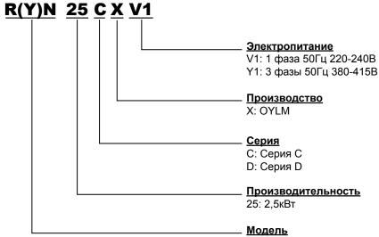
RR и RN: Одиночный конденсаторный блок сплит-системы (только охлаждение) RYN и RQ: Одиночный конденсаторный блок сплит-системы (тепловой насос)
