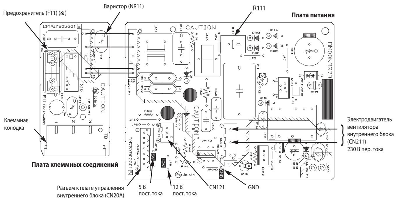
※ После отключения платы подключения внутреннего блока, замените предохранитель.
