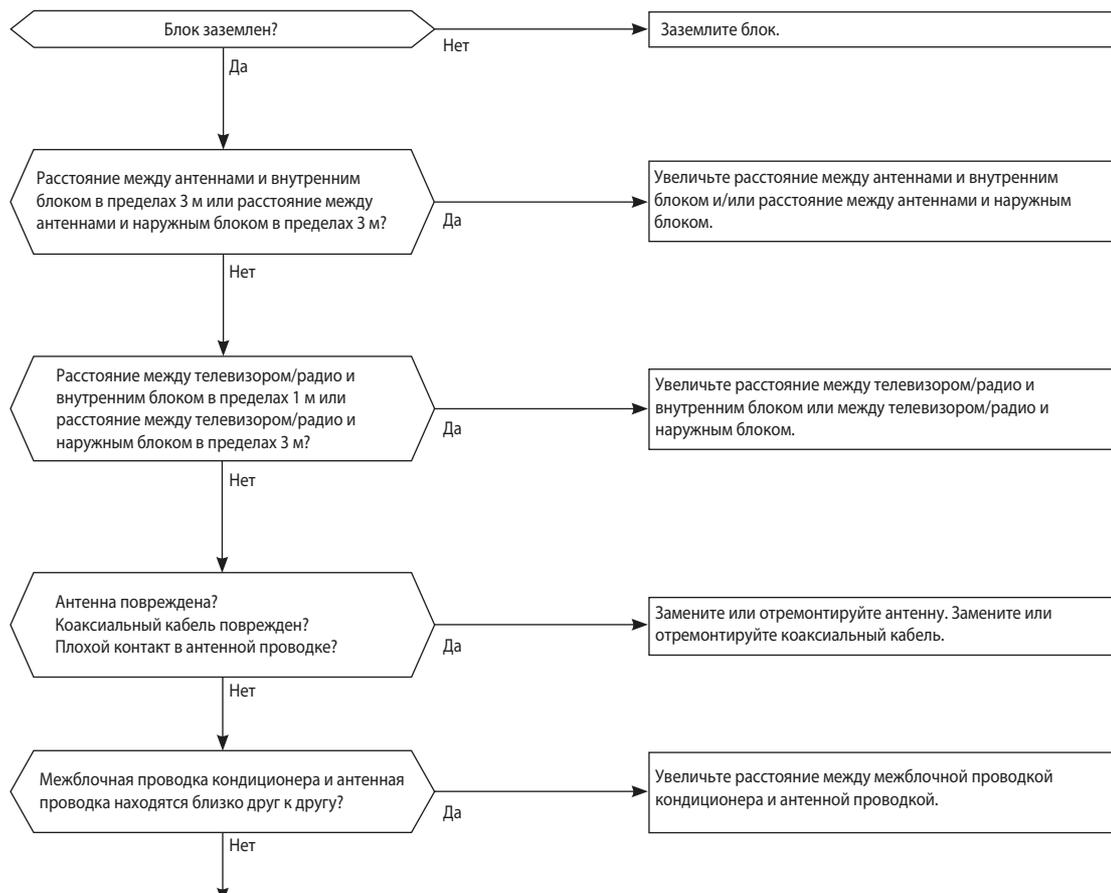
Даже если перечисленные выше требования выполнены, электромагнитные помехи все же могут проникать в приемно-передающую аппаратуру. Это может быть обусловлено величиной напряженности электрического поля и особенностями антенно-фидерных устройств (комбинация специфических условий, таких как антенны или проводка).
