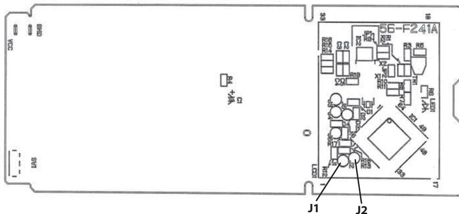
2) На печатной плате пульта отмечены отверстия под установку перемычек «J1» и «J2».
