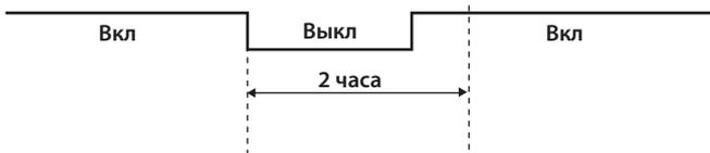
Когда система перезапускается через 2 или более часа, режим работы определяется комнатной температурой при запуске режима.
