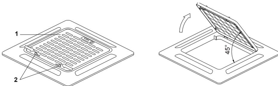
1 — панель; 2 — фиксаторы
