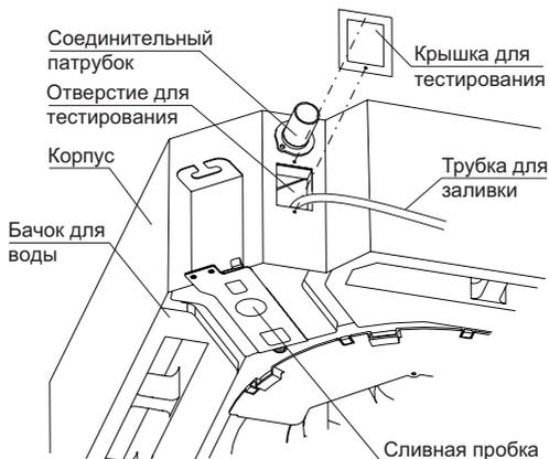
3. Включите питание и запустите кондиционер в режиме охлаждения. Наблюдайте работу помпы (движение конденсата через выходную трубу). Убедитесь в том, что вода сливается (учитывая длину дренажной трубы, вода может появиться с задержкой примерно на 1 минуту), проверьте герметичность соединений.
