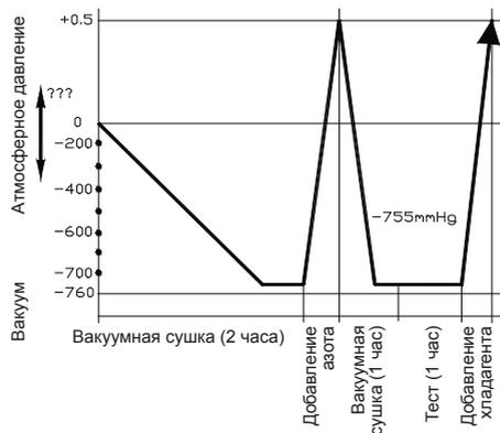
После первого вакуумирования добавьте в контур осушенный азот при давлении до 25 кг/см<sup>2</sup> на 30 минут. Удалите азот и снова откачайте систему.
