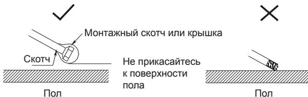
4. Отрежьте трубу и удалите заусеницы, направив обрабатываемый конец вниз.
