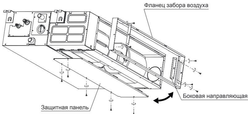
Установите планку с защитным покрытием, закрепите направляющие и фланец, закрепите защитную крышку.
