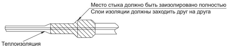
Теплоизоляцию закрепите монтажным скотчем.
