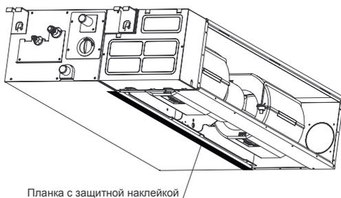
Установите воздушный фильтр (опция, приобретается отдельно). При установке фильтра приклоните его сначала со стороны выходного отверстия для воздуха, задвиньте внутрь и вверх.
