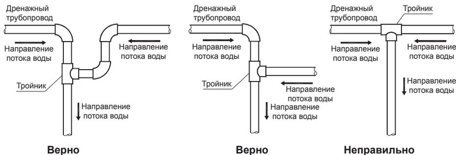
Правильная установка дренажного трубопровода не вызовет обратного перетока воды во внутренний блок. Неверная установка может привести к протечке конденсата из внутреннего блока из-за перетока воды.
