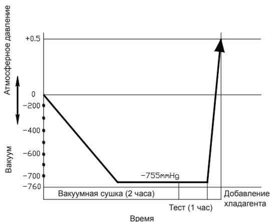
При первой установке блока на только что поставленные трубопроводы нет необходимости вакуумировать систему 2 часа, при условии, что установка трубопроводов проходила при отсутствии атмосферных осадков и при относительной влажности воздуха не более 60%. Если установка трубопроводов проходила под осадками или при повышенной влажности, необходимо проводить вакуумирование в полном объеме.
