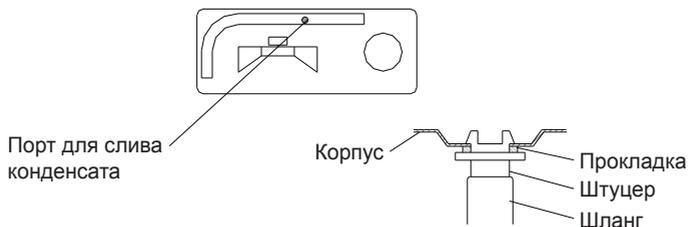
При необходимости используйте сливной штуцер для подключения шланга для слива конденсата к наружному блоку. Штуцер подключается с нижней части наружного блока, под теплообменником.
