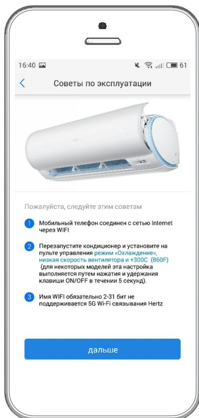
Перед выполнением привязки кондиционера (пункт 2 на рис.13), полностью обесточьте кондиционер (физически отключите от сети питания) на 2-3 минуты, а при первом включении сделайте нужные установки (пункт 2 на рис.13). Требуемая температура имеется ввиду 30 градусов, просто знак градуса в используемом русском шрифте отображается как ещё один ноль
