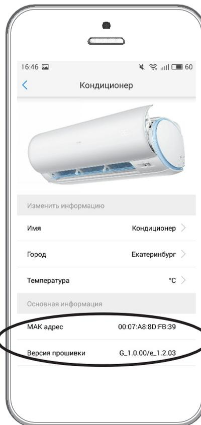
Старые Wi-Fi модули mod.25033107L на рис.19 подключены к серверу, который находится в КНР, из-за этого, при определенных обстоятельствах, могут возникнуть трудности доступа к серверу, поэтому мы рекомендуем обновить программное обеспечение старых модулей до новой версии программного обеспечения G\_1.0.00/e\_1.2.02 следующим образом:
