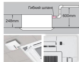
**КОМПАКТНЫЕ.** Корпус внутреннего блока имеет малую высоту – всего 248 мм, ширина и глубина у всех моделей серии одинакова – 570\*570 мм, т.е. для всех моделей потребуется одинаковый проем в потолке. Это обеспечивает аккуратный внешний вид потолка после осуществления монтажа, даже при установке блоков разной производительности.
