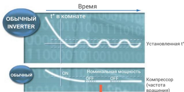
Менее передовая технология не регулирует циклы ВКЛ/ВЫКЛ.
