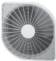
Форма решетки в виде листа разработана с целью уменьшения возмущений, вносимых в поток воздуха, создаваемый вентилятором. Решетка оказывает минимальное сопротивление воздушному потоку и делает его более равномерным, снижает нагрузку на электродвигатель и увеличивает энергоэффективность кондиционера.
