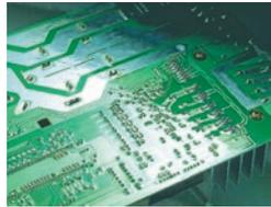
Плата микропроцессора защищена специальным силиконовым слоем, обеспечивающим защиту от влаги и больший срок службы.
