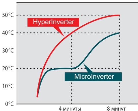
Температура поступающего в помещение из кондиционера воздуха может достичь 40°C уже через 4 минуты после включения последнего при температуре наружного воздуха на уровне около 0°C, а через 8 минут температура воздуха на выходе из кондиционера достигнет уже 50°C.
