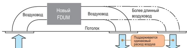
**ПРОСТЫЕ В ПРОЕКТИРОВАНИИ.** Система обладает широким диапазоном изменения внешнего статического давления (от 10 до 100 Па), что значительно упрощает проектирование воздуховодов. При помощи DC-электродвигателя вентилятора оптимальный расход воздуха достигается автоматически.
