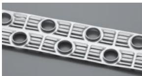
Оптимизация расположения медных трубок и формы ребрения позволила уменьшить сопротивление воздушного потока. Эффективность теплообменника повышена на 33%. Новая форма ребрения обеспечивает одновременно максимальный расход воздуха, минимальное сопротивление и высокий уровень теплосъема.
