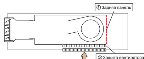
ИНВЕРТОРНЫЕ СПЛИТ-СИСТЕМЫ КАНАЛЬНОГО ТИПА SRR ЯВЛЯЮТСЯ КОМПАКТНЫМИ И «ТОНКИМИ», ВЫСОТА БЛОКА НЕ ПРЕВЫШАЕТ 200 ММ ДЛЯ ВСЕХ ТИПОРАЗМЕРОВ В РАМКАХ СЕРИИ, ТАКИМ ОБРАЗОМ, ЗАНИЖЕНИЕ ПОТОЛКА В МЕСТЕ УСТАНОВКИ НЕ БУДЕТ КРИТИЧЕСКИМ. ЗАБОР ВОЗДУХА МОЖЕТ ПРОИЗВОДИТЬСЯ СНИЗУ ИЛИ С ТЫЛЬНОЙ СТОРОНЫ.
