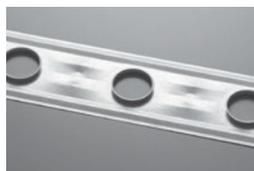
Форма ребер теплообменника изменена с плоской на рифленую, что позволило повысить эффективность на 10%. Объемная структура позволяет получить оптимальный баланс расхода воздуха и эффективного теплообмена.
