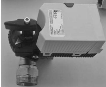
**!** После установки привода на трехходовой клапан необходимо проверить направление вращения привода (см. инструкцию на приводы серии 225). При работе трехходового клапана на смешение привод должен вращаться по часовой стрелке.
