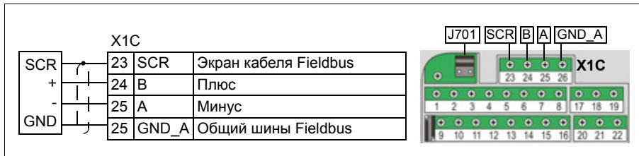
Замкните шину EIA-485 резистором 120 на конце цепочки, установив шунтирующие перемычки J701, как показано на приведенном ниже рисунке.
