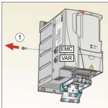
**Примечание.** В корпусе типоразмера R4 винт ЭМС находится справа от клеммы W2.
