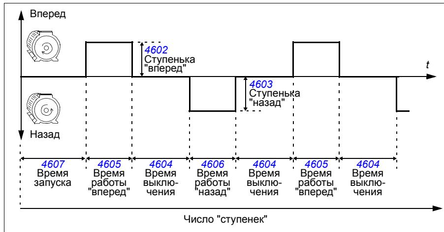
Цикл очистки насоса может включаться при запуске, по истечении периода времени, заданного пользователем, с помощью выбираемого цифрового входа или функцией контроля (запускаемой, например, входным током двигателя).
