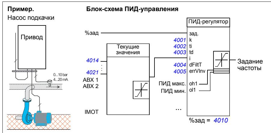
На следующем рисунке показана блок-схема системы регулирования скорости/скалярного управления для регулятора технологического процесса ПИД 1.
