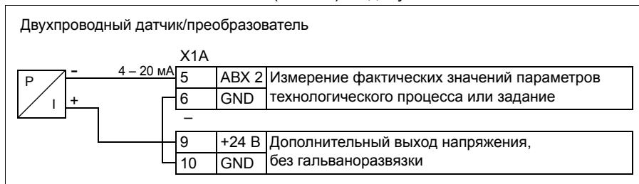
**Примечание.** Датчик питается через свой токовый выход, а привод подает напряжение питания (+24 В). Таким образом, выходной сигнал должен быть 4 – 20 mA, но не 0 – 20 mA.
