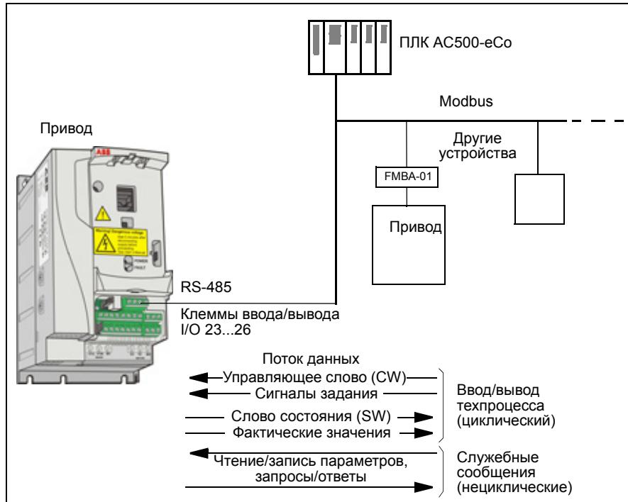
Значения по умолчанию прикладного макроса AC500 Modbus для параметров привода соответствуют стандартному макросу ABB (параметр [9902](#), значение 1 ([ABB СТАНДАРТ](#))), см. раздел [Стандартный макрос ABB](#) на стр. 114), но со следующими отличиями:
