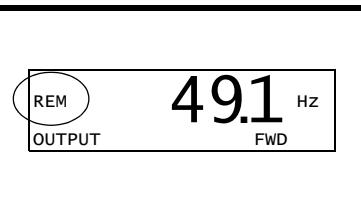
Пользователь может подавать сигналы на два входа внешнего управления **ВНЕШНИЙ 1** или **ВНЕШНИЙ 2**. В каждый момент времени один из них будет активен в зависимости от выбора пользователя. Эта функция работает с циклом 2 мс.
