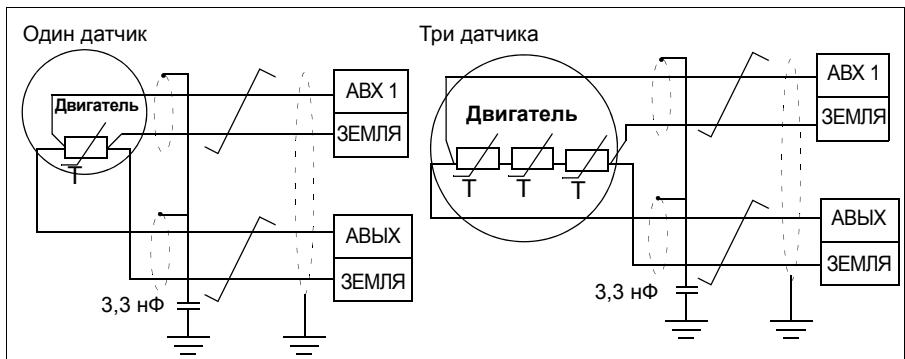
**ПРЕДУПРЕЖДЕНИЕ!** В соответствии со стандартом IEC 664, при подключении датчика температуры двигателя необходимо обеспечить двойную или усиленную изоляцию между токоведущими частями двигателя и датчиком. Усиленная изоляция подразумевает величину зазора и длину пути утечки 8 мм (для оборудования с номинальным напряжением питания 400/500 В~).
