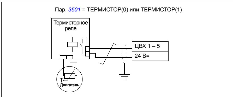
**ПРЕДУПРЕЖДЕНИЕ!** В соответствии со стандартом IEC 664, при подключении термистора двигателя к цифровому входу необходимо обеспечить двойную или усиленную изоляцию между токоведущими элементами двигателя и термистором. Усиленная изоляция подразумевает величину зазора и длину пути утечки 8 мм (для оборудования с номинальным напряжением питания 400/500 В~).
