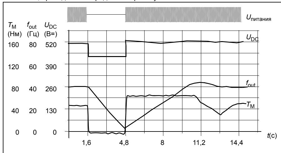
$U_{DC}$  = напряжение звена постоянного тока привода,  $f_{out}$  = выходная частота привода,  $T_M$  = крутящий момент двигателя
