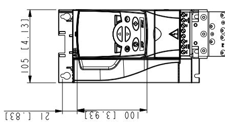
Типоразмер R2, IP20 (монтаж в шкафу) / UL, открытое исполнение
