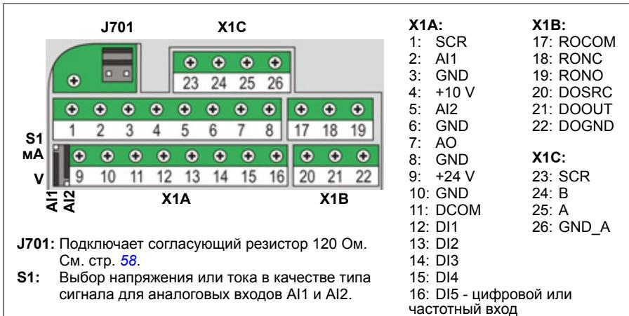
**ПРЕДУПРЕЖДЕНИЕ!** Все цепи ELV (сверхнизкое напряжение), подключенные к приводу, должны быть использованы внутри зоны эквипотенциального заземления, т.е. внутри зоны, где все проводящие части, к которым возможен одновременный доступ, электрически соединены для предотвращения появления опасных напряжений между ними. Это достигается соответствующим заземлением на заводе-изготовителе.
