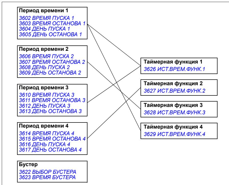
Параметр, который включается таймерной функцией, одновременно может быть связан только с одним таймером.
