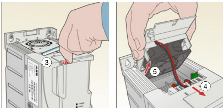
6. Отсоедините кабель вентилятора. На приведенном ниже правом рисунке показано местонахождение разъема кабеля вентилятора в приводе типоразмера R2. Вид изнутри приводов разных типоразмеров не одинаков, но разъем кабеля вентилятора всегда находится на плате управления спереди привода.
