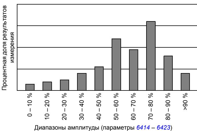
Регистратор амплитудных значений 1 (AL1) предназначен исключительно для контроля тока двигателя и не может быть сброшен. Для регистратора амплитудных значений 1, величина 100 % соответствует номинальному выходному току привода ( $I_{2N}$ ).
